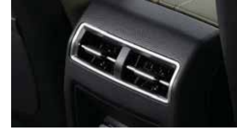
Arka orta konsol havalandırması
